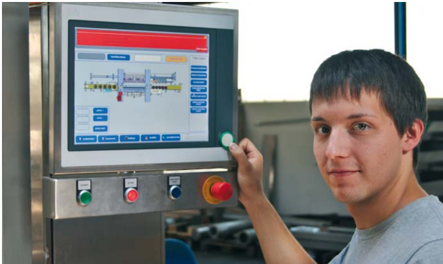
»Die Steuerung läuft unter dem BSR-Betriebssystem Automation Runtime auf einem Power Panel 500 in Edelstahl-Ausführung mit Transponder-Benutzeranmeldung.« Stephan Holz, Elektronik-Programmierer bei AMS.
